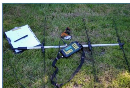
Figure 29: Matériel de télémétrie: Antenne, récepteur, fiche de télémétrie et lampe frontale (Photo: MN)
